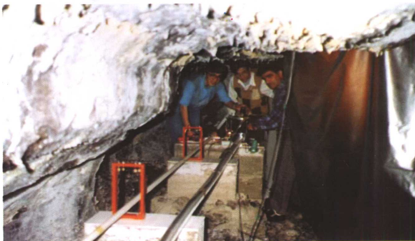
基线38m长的CE-92水平应变和倾斜变化仪器在Cueva站长期运转
