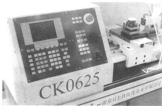
图 1-6 操作面板（OP020）和机床控制面板（MCP）在机床上的安装位置
