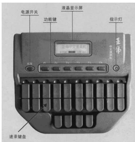
图 2-1 亚伟中文速录机结构图
