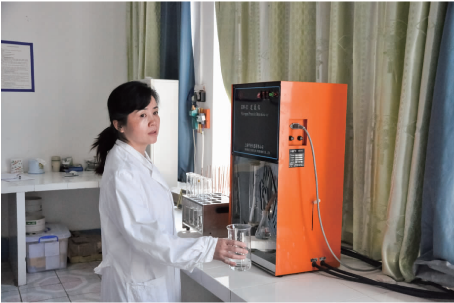
►化验员使用定氮仪进行土壤全氮分析化验。
