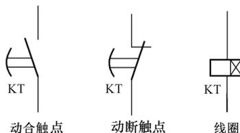
图 1-9 通电延时继电器的符号
