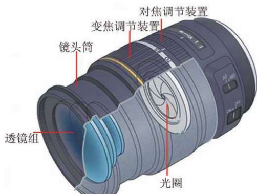
图1-1-19 镜头结构
