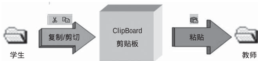
图1-7 “复制/剪切”和“粘贴”操作的原理图
