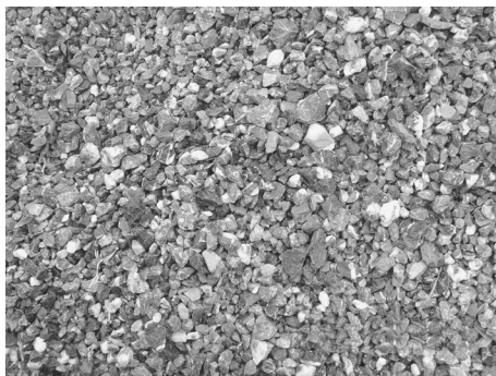
图 1-6 FGD 系统中所用的石灰石
