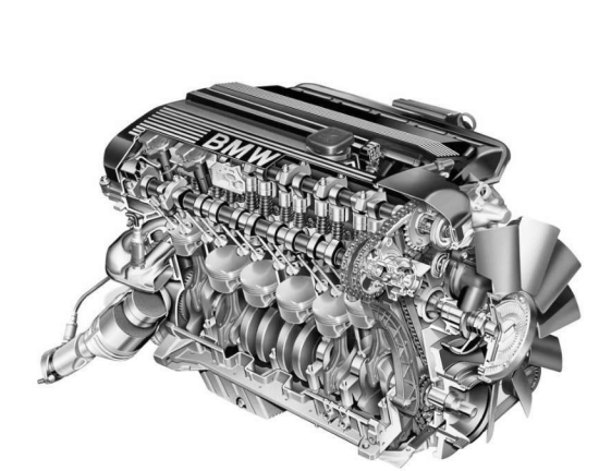
图 1.1.3 宝马汽车汽油机纵剖面
