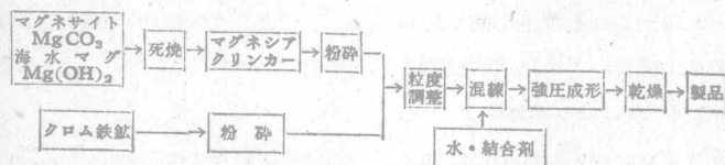
図 2・3 クロマグ系れんがの製造工程
