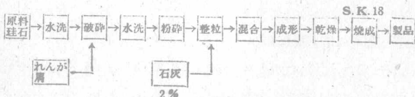
図 2.2 珪石れんがの製造工程
