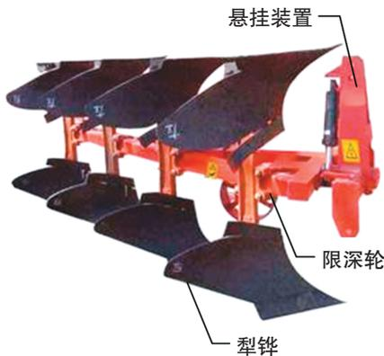
3) 调整中央拉杆。在调整前，先从地边犁耕一趟（作业速度以 5~7 千米/小时为宜），返回时，拖拉机一侧轮胎走犁沟后进行调整。如果
