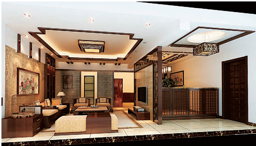
顶面 [ 石膏板造型 + 木线条收口 ]
