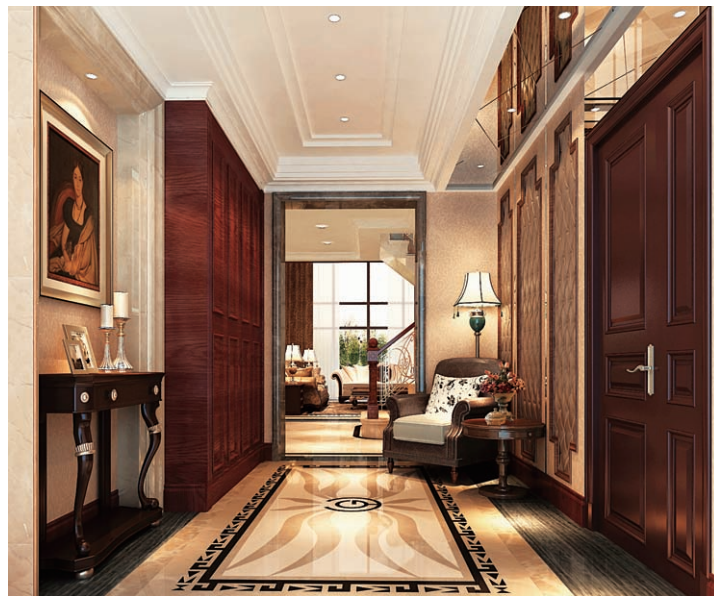
顶面【石膏板造型+银镜拼菱形】右侧墙【布艺软包+木线条包边】
