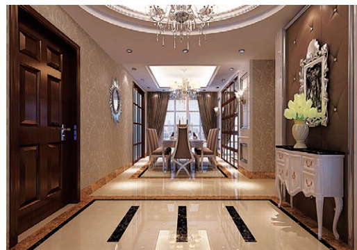
玄关墙【布艺软包 + 不锈钢装饰条收口】
