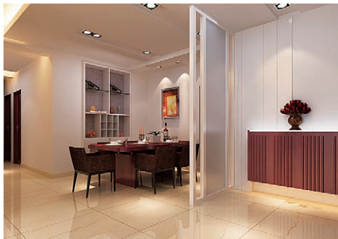
隔断 [ 磨砂玻璃 + 装饰方柱 ]
