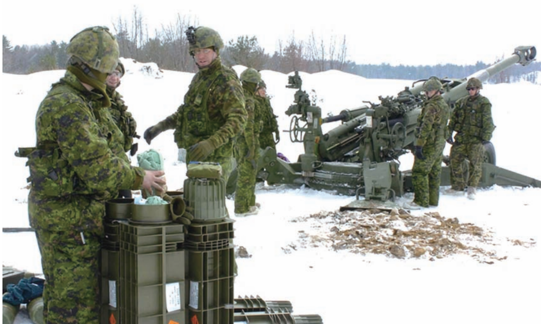
M777系列155mm超轻型榴弹炮的存在，实际上意味着一场炮兵革命的大幕正在徐徐拉开
