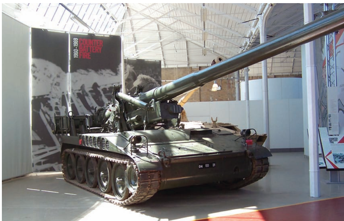
美制M107 175mm自行加农炮虽然在射程上享有一定优势，但其敞开式设计并不适应核生化条件下的战场环境
