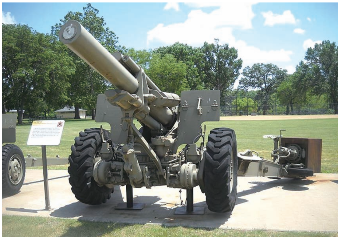
在M114基础上改装辅助动力推进装置的XM123 155mm榴弹炮
