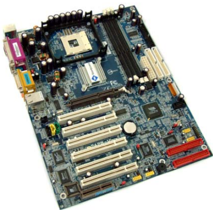
图 1-5 标准 ATX 结构的 Pentium 4 主板
