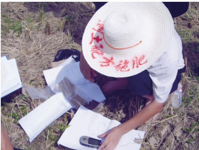
◀ 采样人员现场使用 GPS 仪对采样点进行定位。
