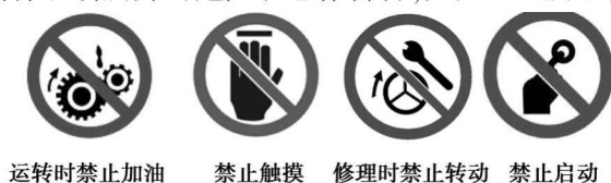
图 1.3 汽车维修厂危险标志
