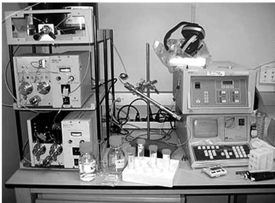
图 1.3 高效液相色谱仪可检测食品中三聚氰胺的含量
