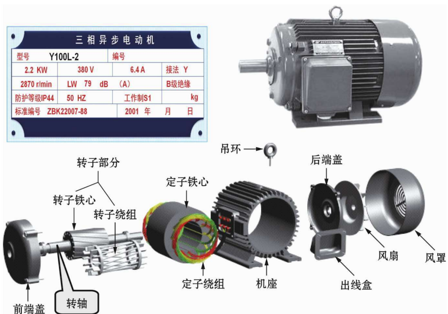
图 1-1 三相笼型异步电动机结构
