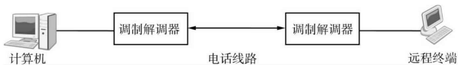
图 1-5 第一代网络结构
