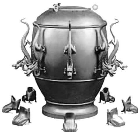
图 1.4 地动仪——测量地震(张衡公元 132 年)
