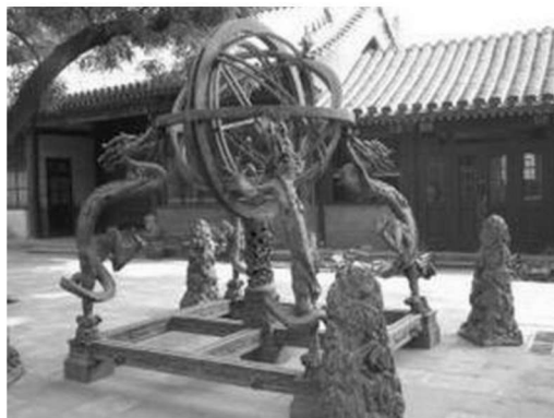
图 1.6 简仪——测定天体方位 (元朝郭守敬 1276 年)
