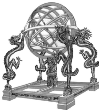
图 1.3 浑天仪——测量天体球面坐标(张衡公元 117 年)
