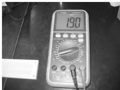
图 1-18 万用表测电压
