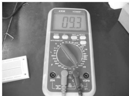
图 1-20 万用表测电流
