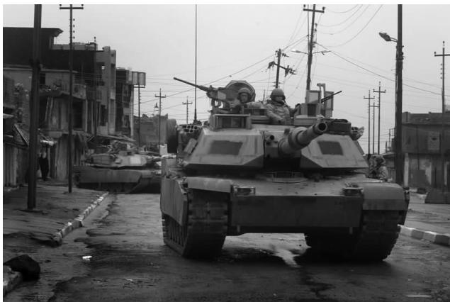
美国 M1A2 坦克上配备 M256 型 120 毫米滑膛炮，其有效射程达 3500 米。该型坦克炮发射贫铀穿甲弹时，在 2000 米距离上，可击穿 700 毫米厚的均质钢装甲。该坦克发射尾翼稳定脱壳弹的炮口动能已经达到 10 兆焦（1 兆焦 =  $1 \times 10^6$  焦耳）。这一能量用来做功，足以把 50 000 千克的主战坦克提举到 6 层楼（约 20 米）高。海湾战争中，美军 M1A2 坦克的 120 毫米滑膛炮发射的 M829A1 贫
