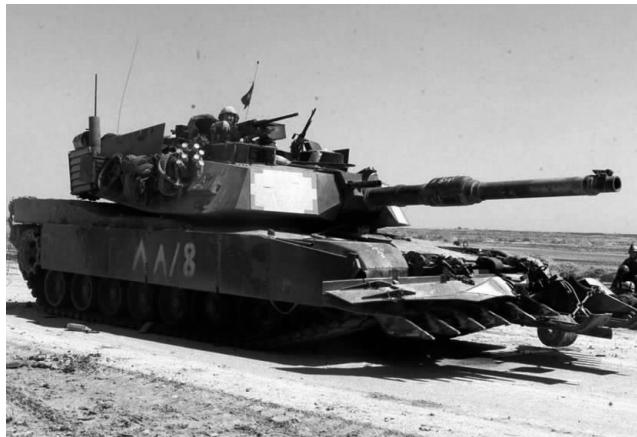
M1 系列坦克是典型的炮塔型坦克，有 4 名乘员。车体前部是加强舱，中部是装甲战斗舱，后部是动力舱。驾驶员位于车体前部，配有 3 具整体式潜望镜。闭窗行驶时，驾驶员半仰卧驾驶坦克，夜间驾驶时可把中间的潜望镜换成 AN/VVS-2 微光夜间驾驶仪。驾驶员两侧是用装甲板隔离的燃料箱和弹药，用以保护车组人员的安全。旋转炮塔位于车体中央，其结构特点是低矮而坚固，几乎与车体一样宽。炮塔和车体各部分装甲厚度不均，最厚达 125 毫米，最薄为 12.5 毫米，相差 10 倍。装甲钢板的厚度自下而上逐渐增厚，为 50 ~ 125 毫米。炮塔内有 3 名乘员，装填手位于火炮左侧，车长位于右侧，炮长在车长前下方。装填手舱门上安装有 1 具可旋转的潜望镜，舱口有一环形机枪架。
