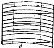
图4 压成弧形的磁极线圈
