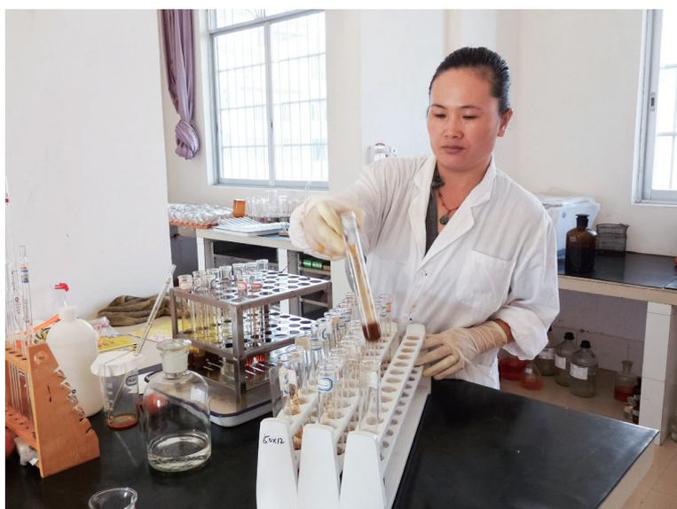
化验人员在化验室进行土壤有机质分析化验
