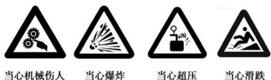
图 1.4 汽车维修厂注意标志
