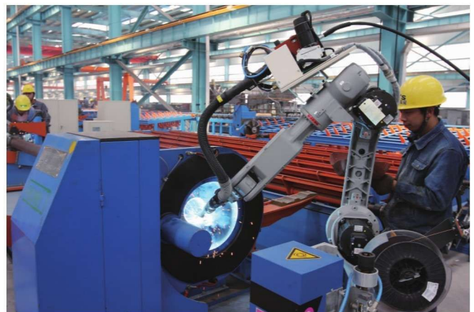
为上海江南管业有限公司提供的管子-法兰机器人自动焊接生产线
