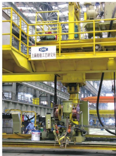
为广州龙穴造船有限公司提供的门架式双丝埋弧焊接系统
