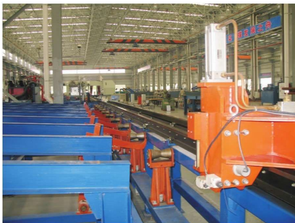
为广州黄埔造船有限公司提供的管子定长切割生产线
