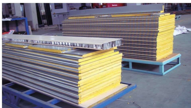
酚醛泡沫绝热保温材料应用于舱室壁板
