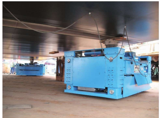
为江南造船(集团)有限责任公司提供的步行式移船定位系统在大型船体分段安装中应用
