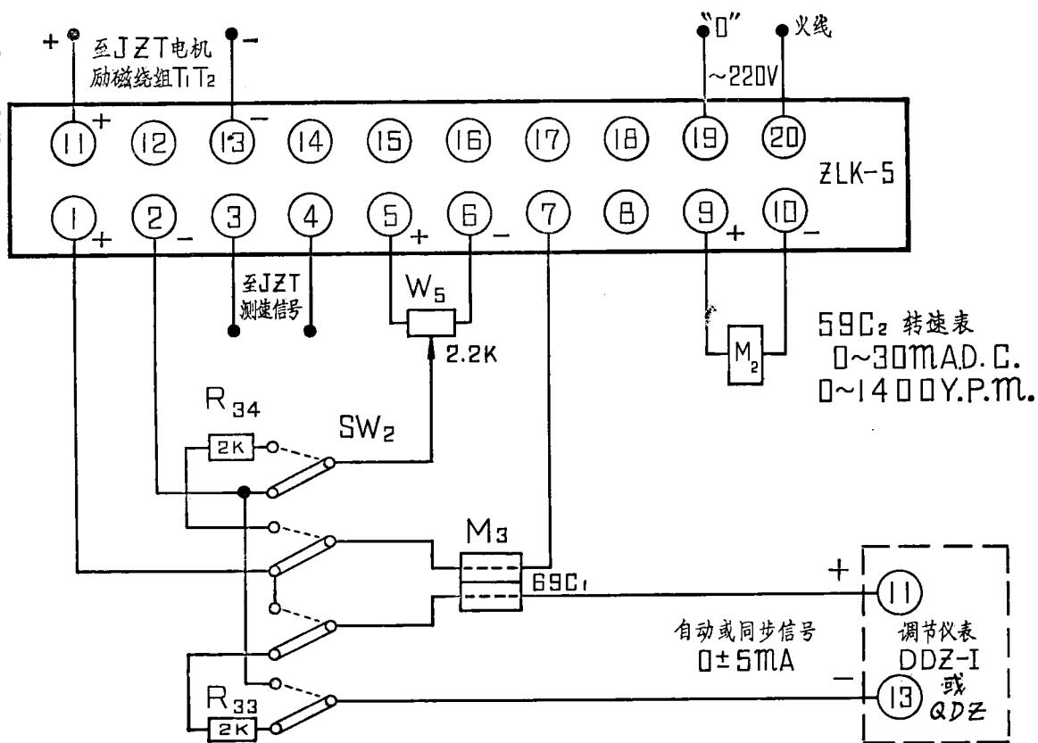
图 12 控制信号为  $0 \pm 5 \text{ mA}$  时的接线图
