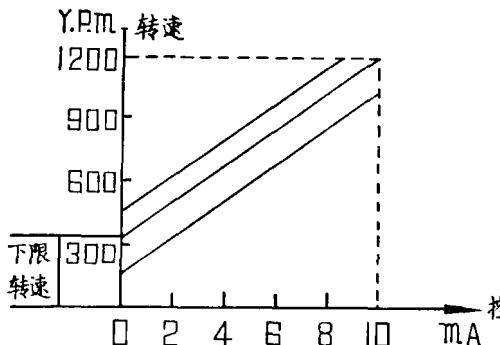
图 14 改变 W<sub>3</sub> 时的控制特性变化
