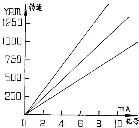
图 13 改变给定电位器  $W_1, W_2$  时的控制特性
