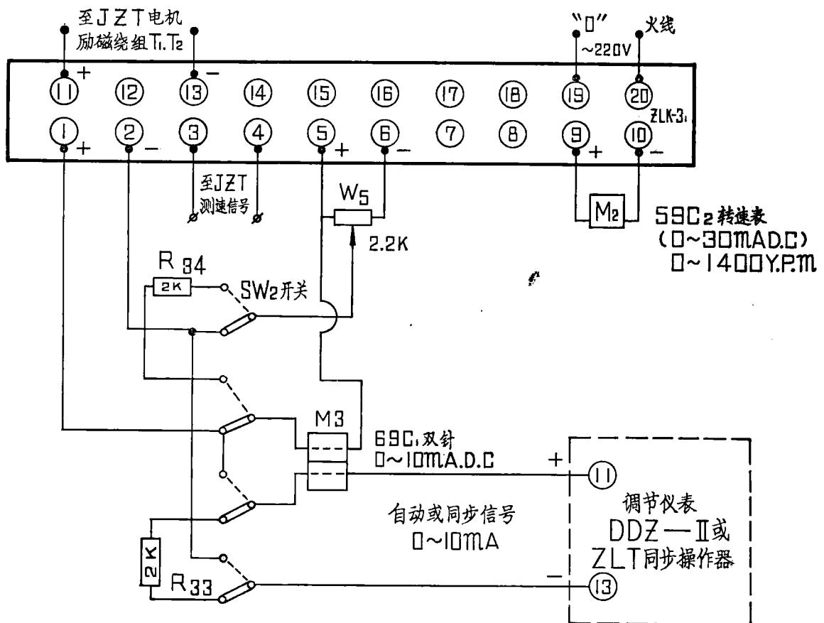
图 11 控制信号为 0~10 mA 时的接线图
