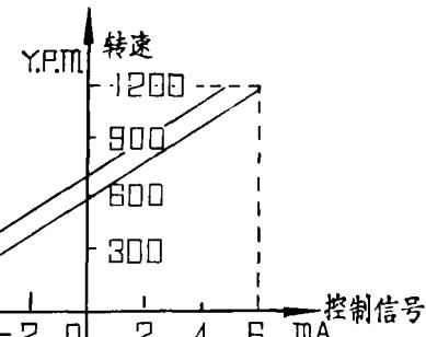
图 15 控制信号为 0~±5 mA 时的控制特性
