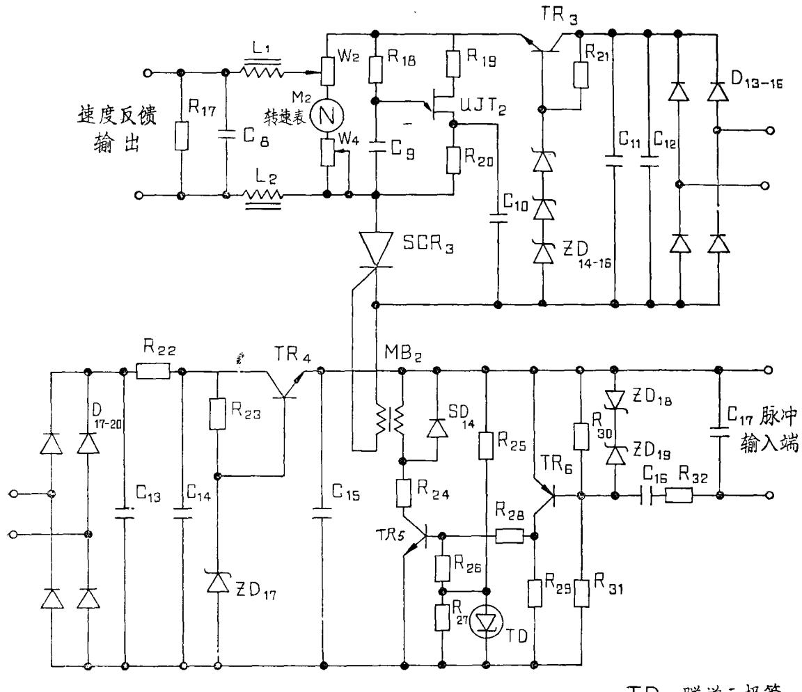
图 5 脉冲测速部分原理图
