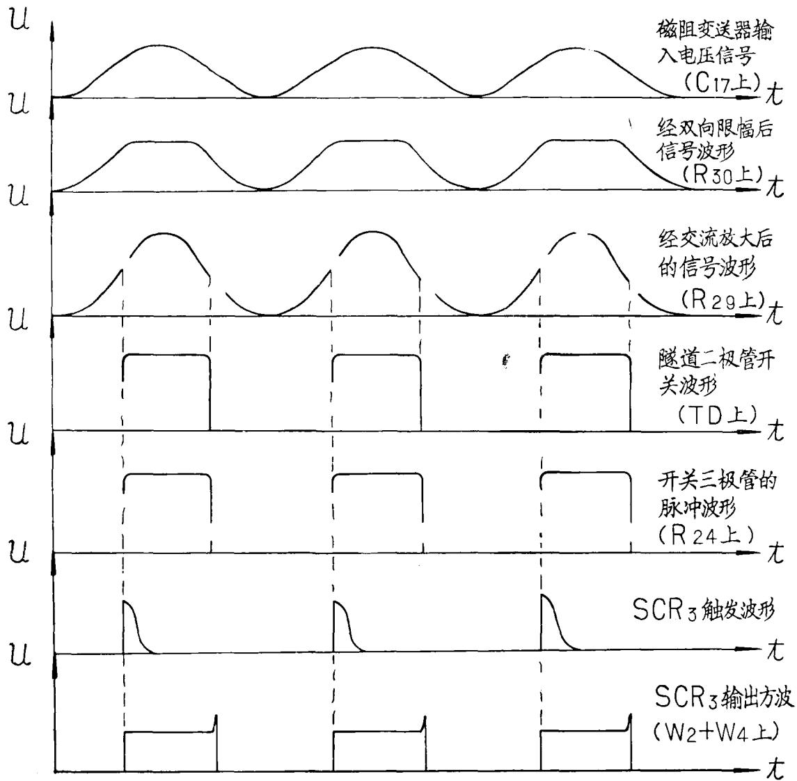
图 6 脉冲测速部分各点波形
