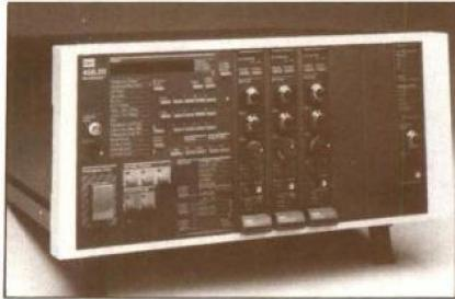
这种新的以微处理机为主要部分的“Micro Console(微型控制台)”控制器，具有进行动态或静态材料试验所必需的全部特点。另外，控制器为紧凑的台式结构，与其他公司的大型落地式控制台相比，占地面积少。这种控制器已广泛被世界各国采用，是近几年MTS公司最成功的新产品。
