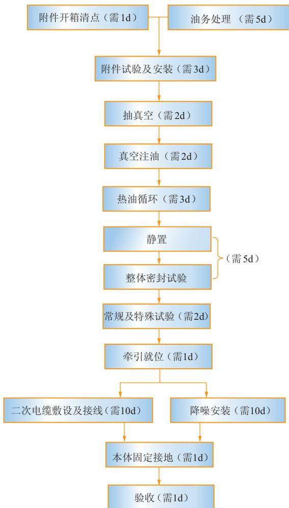
图 1-2 换流变压器安装流程图（方案一）
