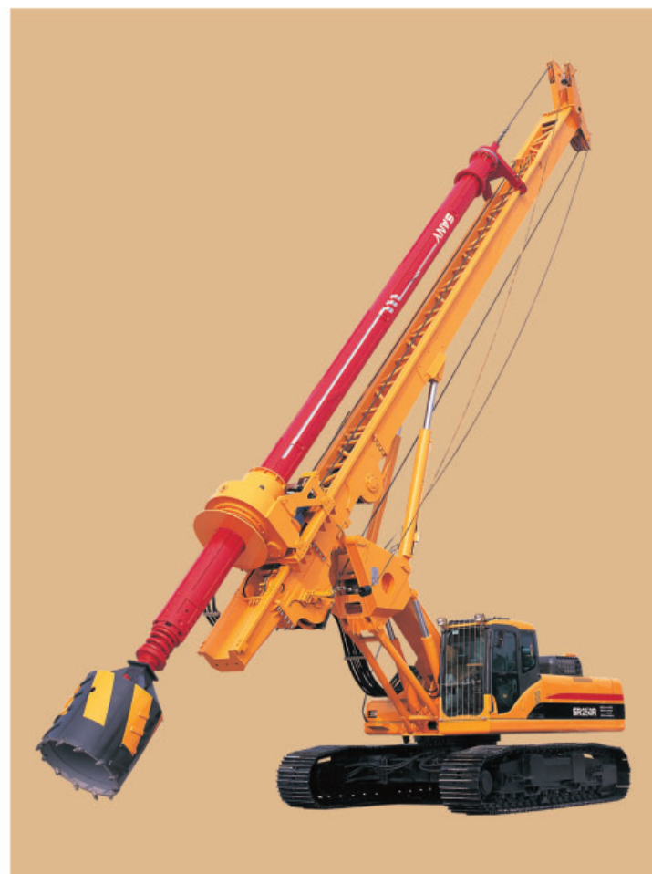
桩机 pile machine
