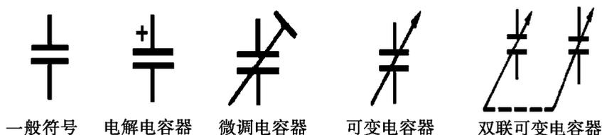
图 1-5 电容器的图形符号
