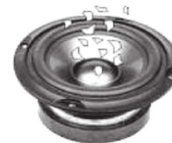
扬声器发声时小纸片上下跳动
