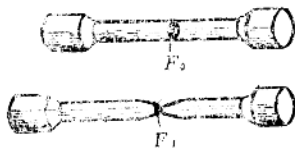
图 1-3 试件在拉力试验前后的横截面积
