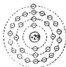
图 1-17 铜原子结构示意图
