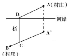
设河岸为对称轴,取 A 的对称点  $A'$ ,联结  $A'B$ ,与另一河岸相交于 C,从 C 向对岸引垂线,垂足为 D。那么 C、D 两点就是两岸架桥的地方,即桥架在线段 CD 的位置。解决这两个问题都用到了同一方法:取某直线为对称轴,作一些图形关于这条对称轴的对称图形,在几何学中这一方法称为对称变换。也称为镜面反射。通过对称变换,有时能把某些隐含的几何性质清楚地显示出来,因而能帮助我们找到解题的途径。
