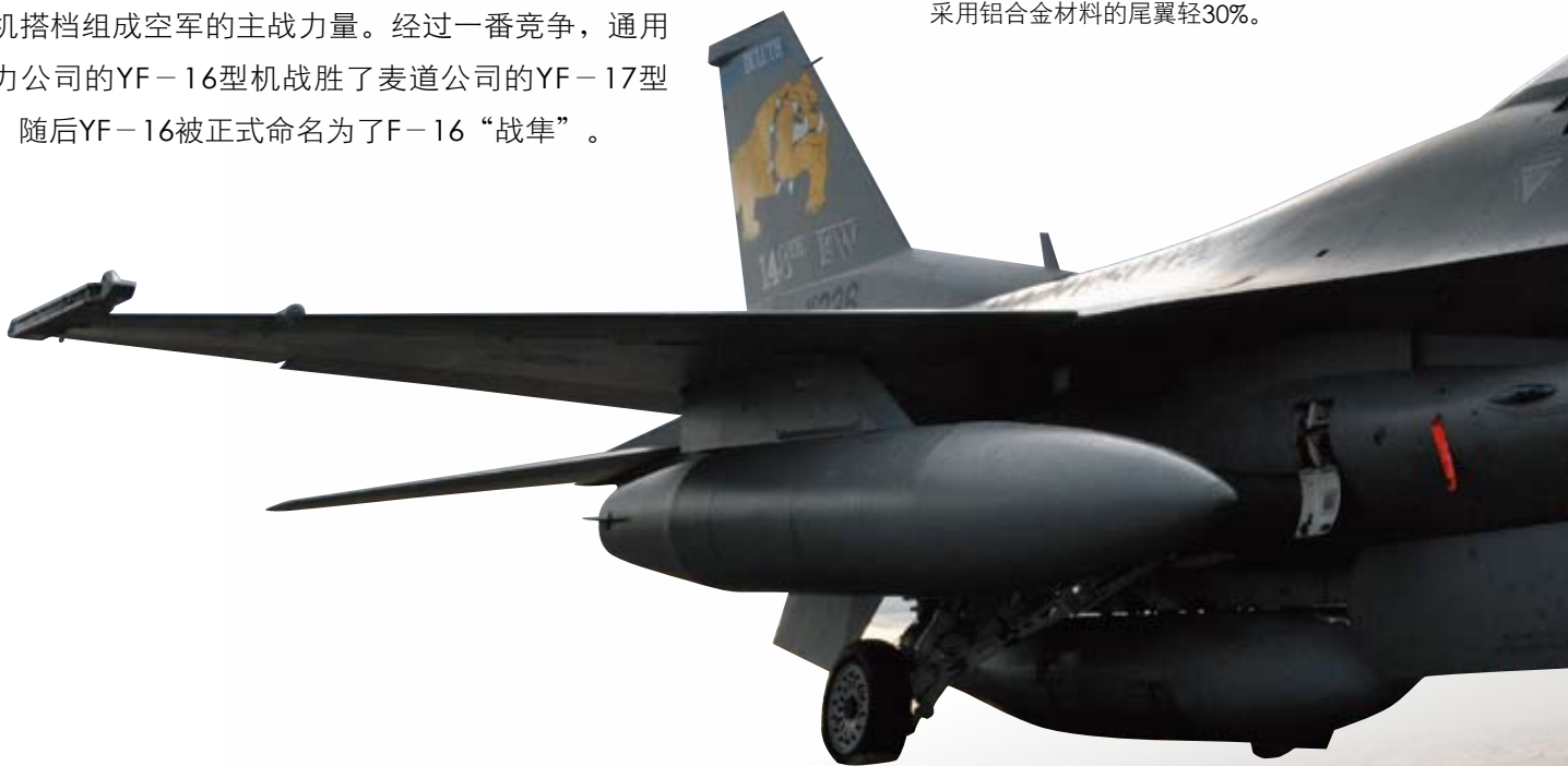
↓ F-16战斗机的尾翼采用复合材料，比采用铝合金材料的尾翼轻30%。
