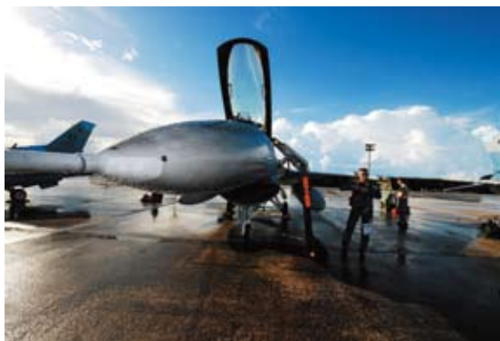
↑ F-16战斗机的座舱采用了气泡式座舱盖，飞行员的视界很宽。
