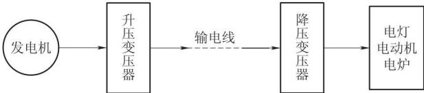
图 1.1 电力系统电路示意图
