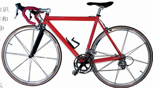
自行车由人力踩动脚踏,通过链条与车后轮之间的齿轮传动,驱车前行。
