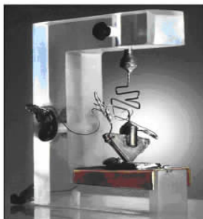
图 1.2 第一只晶体管的照片 [2]
