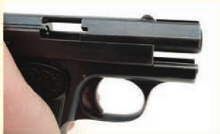
套筒拉动到后方的特写，因为独特的套筒设计，所以并没有设计单独的抛壳窗。
