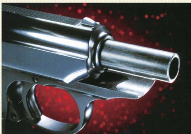
枪管为固定式。该枪采用了自由枪机式自动原理。
