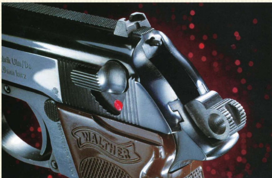
照门的后部可见突出的弹膛指示器杆。这个装置能够在黑夜或手枪放在口袋时，用手确认手枪是否上膛。击锤为外露式，上部有为指示器设置的凹槽。
