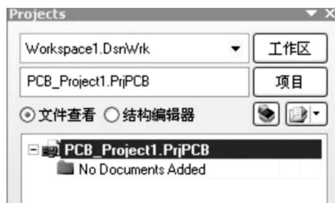
图 1-3 新建的空 PCB 工程
