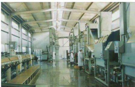
图 1-2 绿茶初制生产线（竹叶青）
