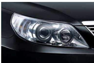
图 1-1-5 外部照明（前照灯总成）
