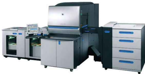
图 1-24 惠普 HP indigo5500 六色数码印刷机
