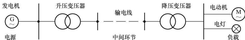
图 1-1 简单电力系统基本结构示意图
