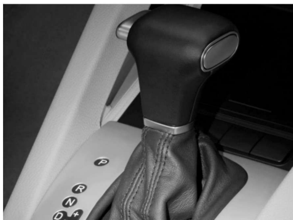
图 1-1-5 变速器操纵杆
