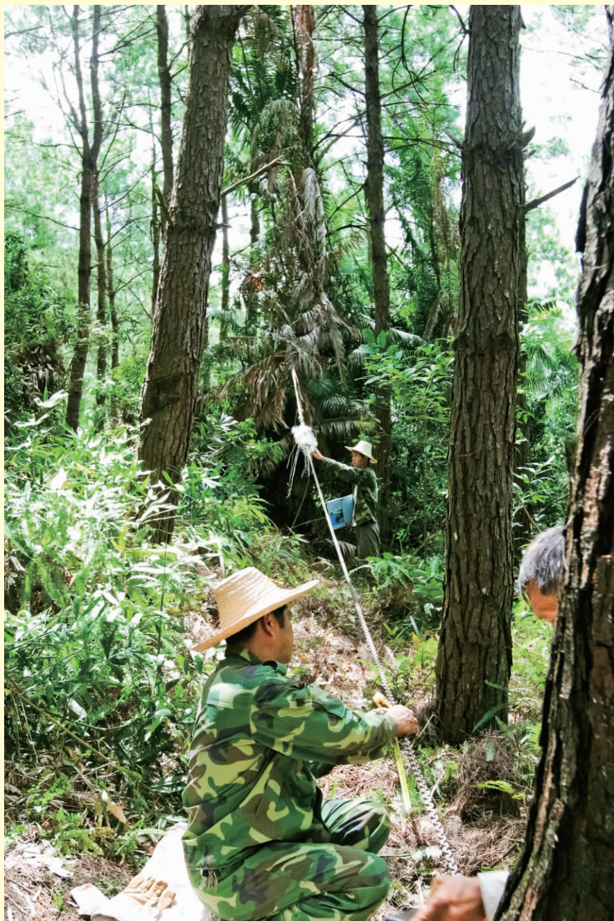
试验人员在进行拽拉力测试试验
