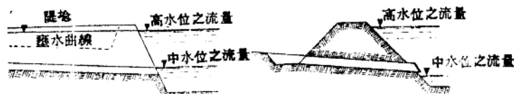
圖1764 排水溝旁之堤埝
