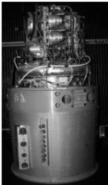
图 1-3 阿波罗登月飞船上使用的 1.5kW 的碱性燃料电池
