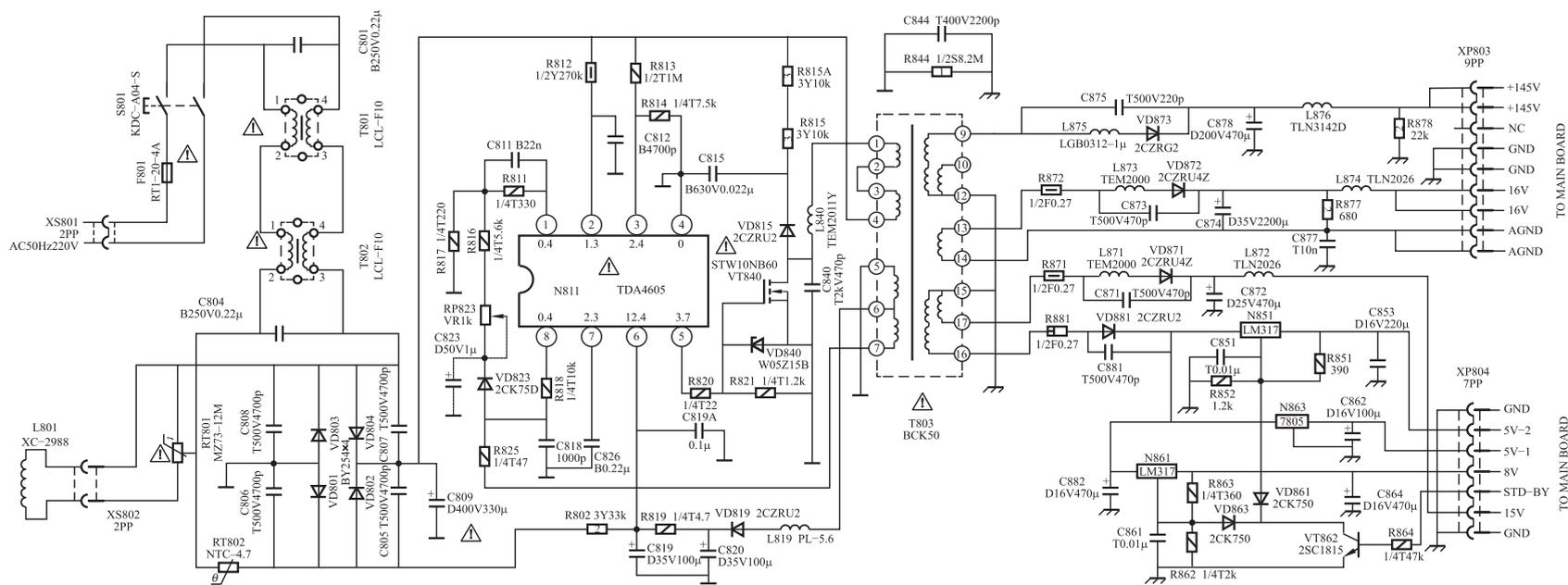
图 1-1 CH-10DR 机芯 (H29D80) 彩色电视机开关电源电路原理图
