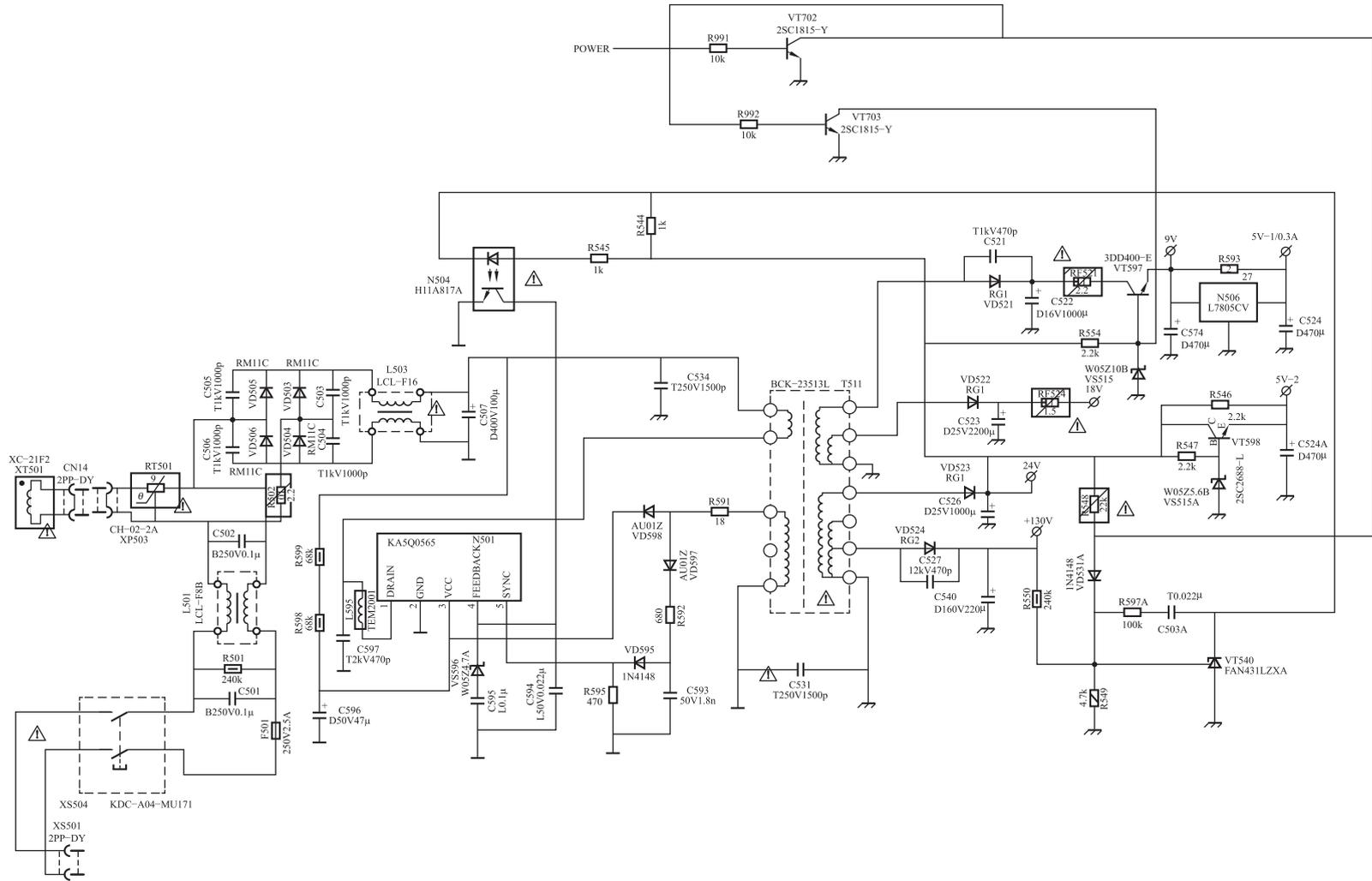
图 1-2 长虹 CH-13A 机芯 (SF2129K) 彩色电视机开关电源电路原理图
