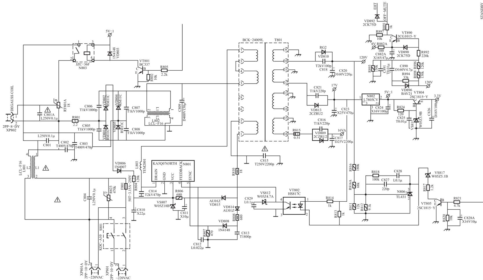
图 1-4 长虹 CH-16 机芯 (PF21156-F35) 彩色电视机开关电源电路原理图
