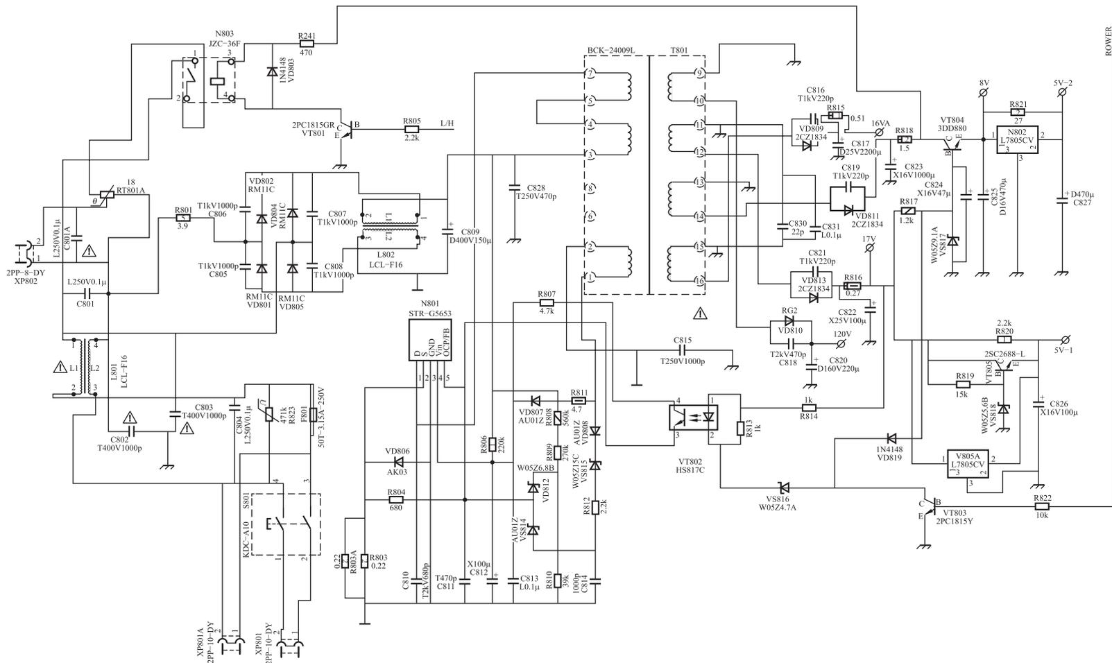
图 1-6 长虹 CH-18G 机芯彩色电视机开关电源电路原理图
