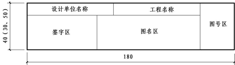
图 1.3 工程图纸标题栏式样
