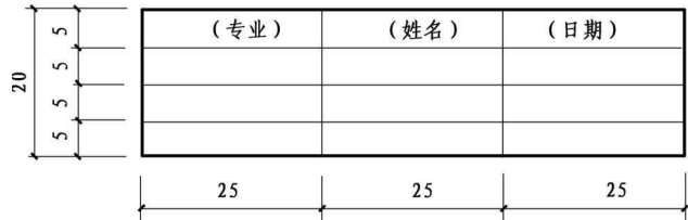
图 1.4 工程图纸会签栏式样
